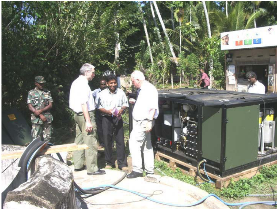
Abbildung 1: Eine Kärcher-Wasseraufbereitungsanlage 1600 G versorgt bis zur Auflösung der Flüchtlingslager täglich 600 Menschen mit einwandfreiem Trinkwasser.
